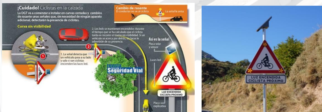
Ilustración 51. Esquema de funcionamiento de la señalización dinámica de ciclistas y ejemplo de instalación. Fuente: DGT
