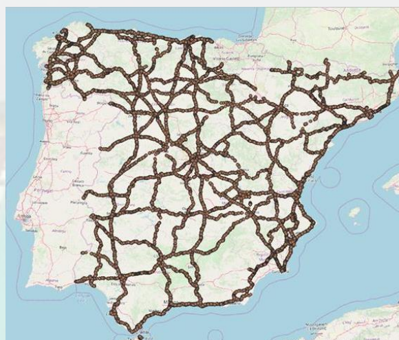
Ilustración 94. Representación GIS de la cobertura de señales de limitación de velocidad incluidas en la BBDD. Fuente: DGT
