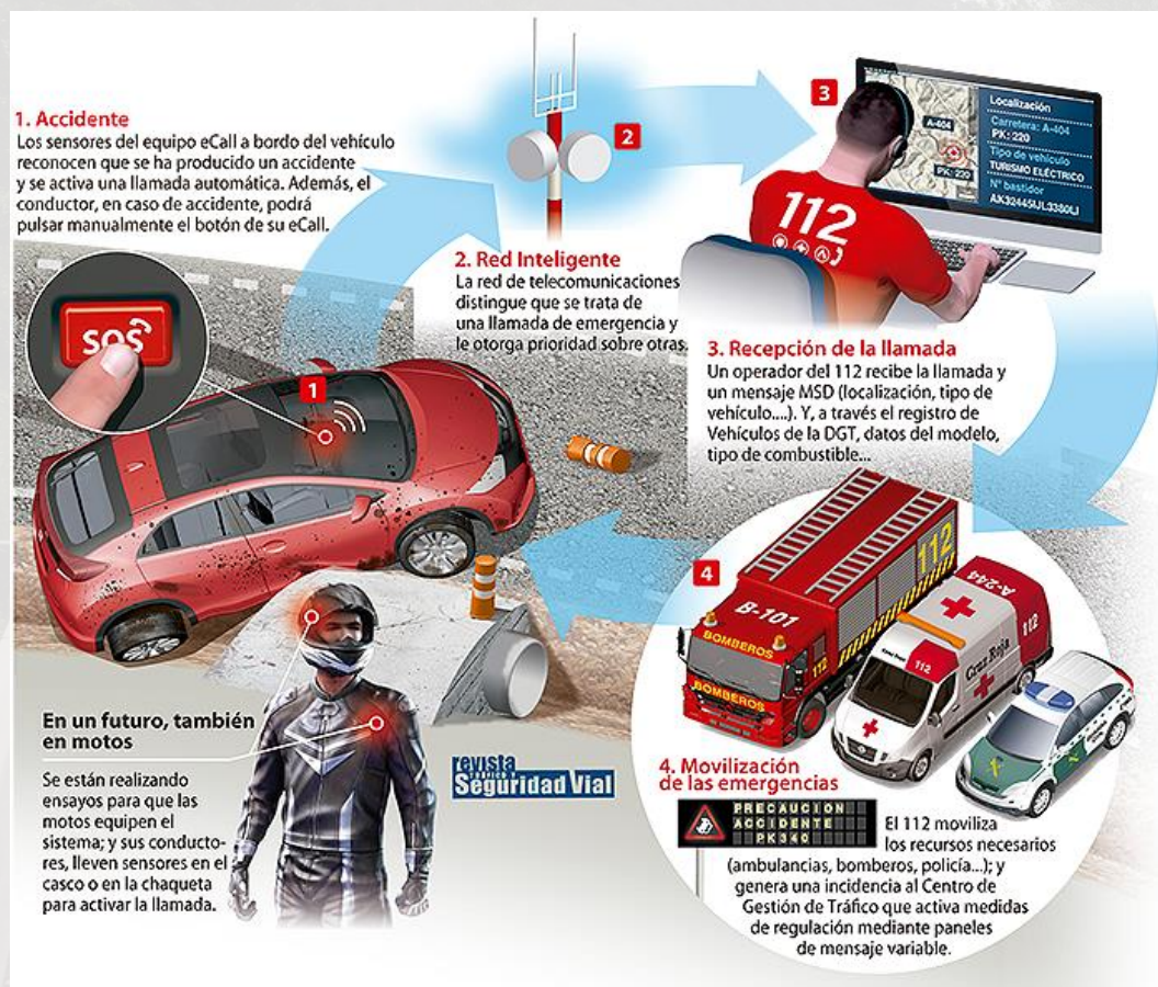
Ilustración 115. Funcionamiento del eCall en España. Fuente: Revista DGT
