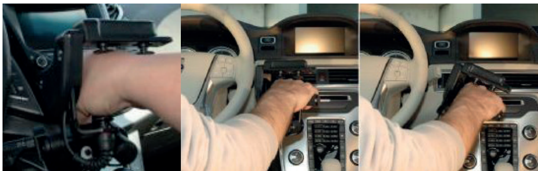
Figura 15. Tetraplejia ACELERADOR ELECTRONICO y FRENO PARA TETRAPLEJICO. Leva de freno FS2001+ empuñadura CL002B. Agosto de 2015.
