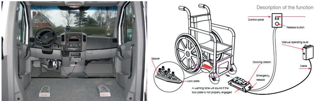
Figura 28. DAHL Docking System distribuye e instala Rehatrans. Octubre 2014.
