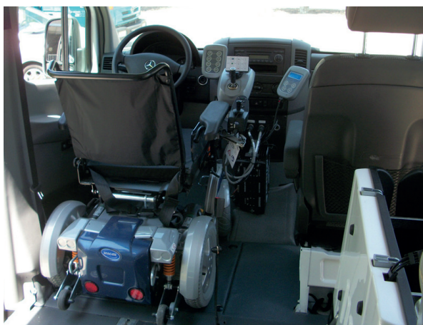
Figura 5. Ejemplo de adaptación y carrozado de un vehículo para ser conducido sin abandonar su silla de ruedas (Fuente: Ilunion Adaptación de Automóviles).
