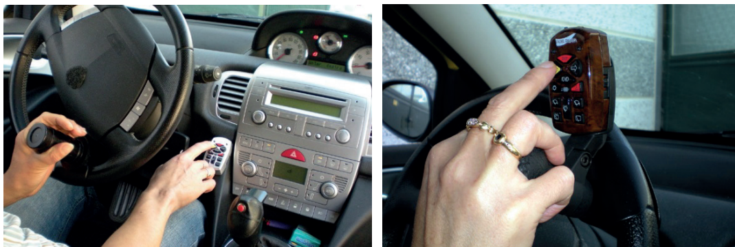
Figura 8. Telecomando 11 funciones diseñado y fabricado por FADIEL distribuido por Euromobility y que instala Rehatrans. Agosto 2015.
