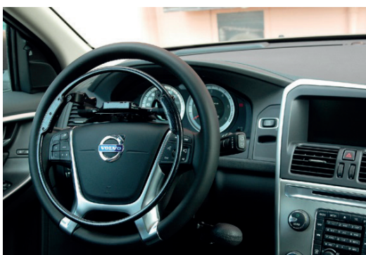
Figura 3. Acelerador aro sobre volante FR33 diseñado y fabricado por FADIEL distribuido por Euromobility y que instala Rehatrans. Agosto 2015.
