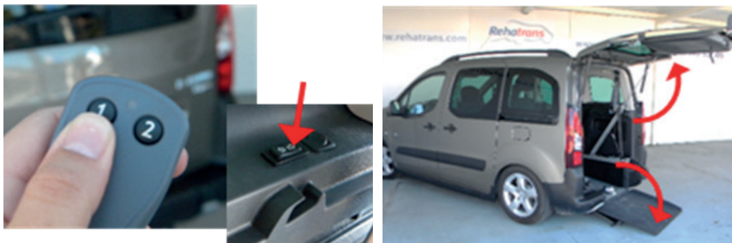
Figura 26. Ejemplo de automatismo en la apertura de puertas, rampas y suspensión. Fabrica Tripod, distribuye e instala Rehatrans. Agosto 2015..
