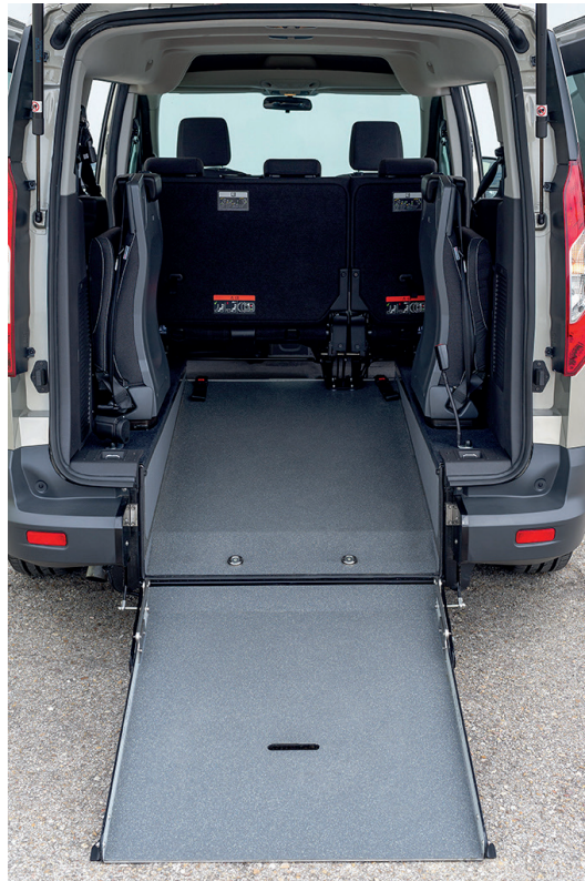
Figura 2. Transformación destinada al servicio de taxi adaptado para personas de movilidad reducida en un Ford Tourneo Connect (Fuente: FORD Adapta).
