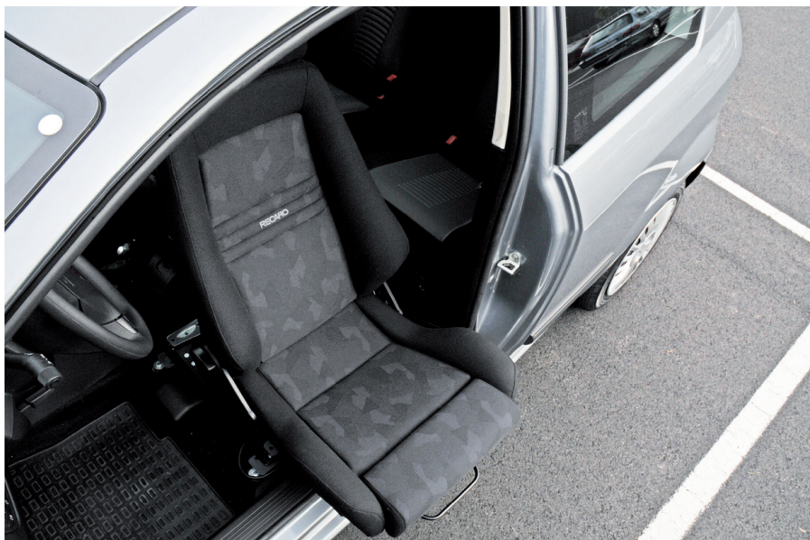
Figura 19. Turnout 2E automático de la marca Autoadapt, distribuye e instala Rehatrans. Agosto 2015.
