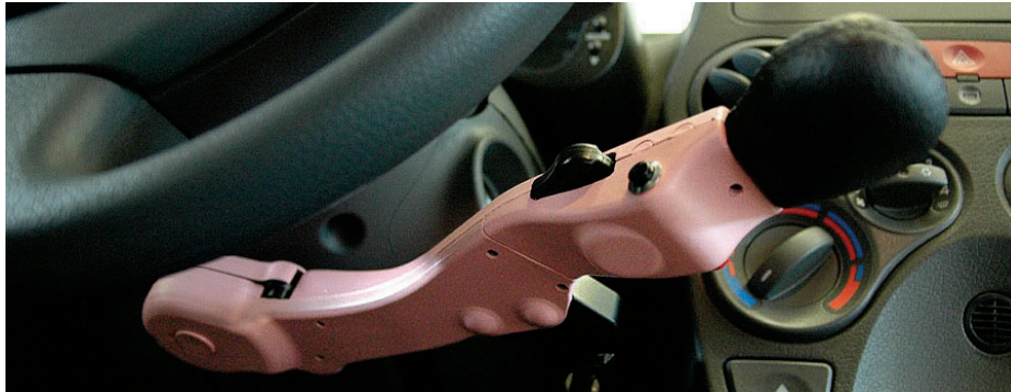
Figura 6. Push&Pull FS2008DM diseñado y fabricado por FADIEL distribuido por Euromobility y que instala Rehatrans. Agosto 2015.
