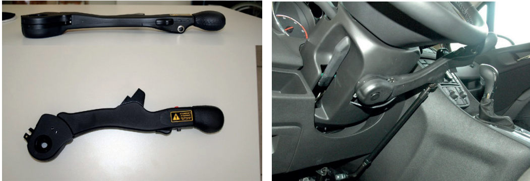
Figura 5. Freno de servicio FS2001, diseñado y fabricado por FADIEL distribuido por Euromobility y que instala Rehatrans. Agosto 2015.
