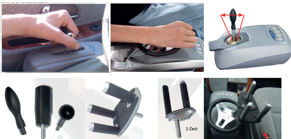
Figura 8. Ejemplos de sistemas de sujeción de mandos de tipo Joystick (Paravan, 2011).
