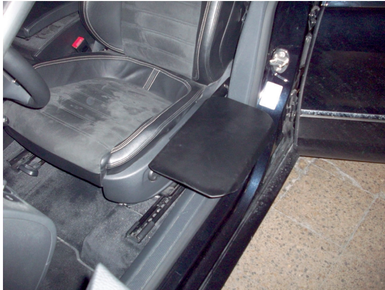
Figura 6. Ejemplo de adaptaciones que no necesitan proyecto técnico. Instalación de ayudas para la transferencia al asiento del acompañante (Fuente: Ilunion Adaptación de Automóviles).
