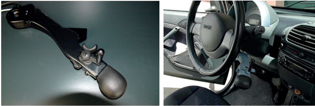
Figura 7. Freno-Acelerador LEVATRONIC FS2005, diseñado y fabricado por FADIEL distribuido por Euromobility y que instala Rehatrans. Agosto 2015.
