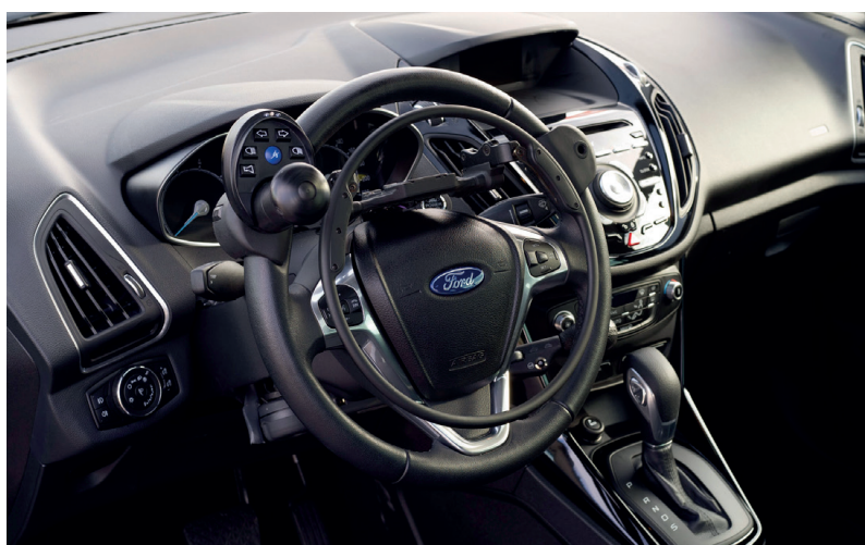
Figura 1. Instalación de acelerador electrónico de aro, como pomo y telecomando por infrarrojos en el volante, leva de freno y cambio automático (Fuente: FORD Adapta).
