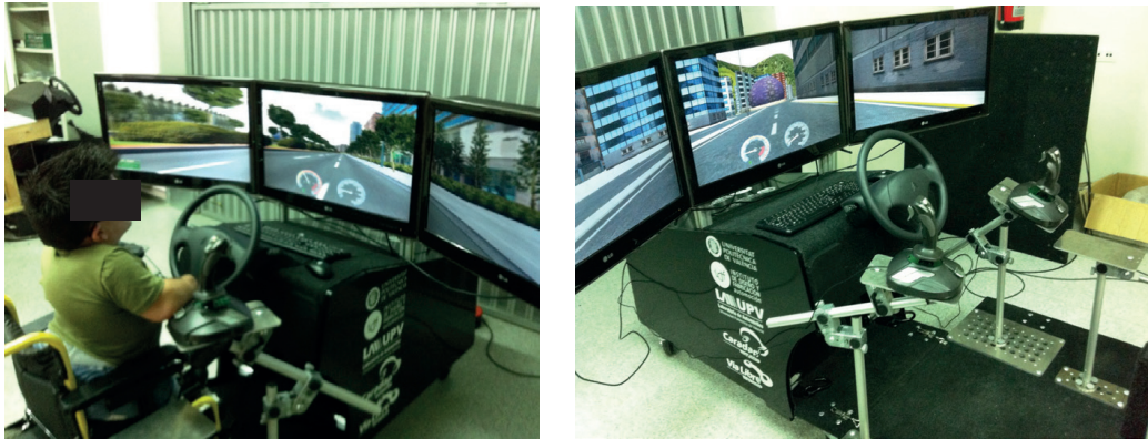
Figura 6. Configuración de diseño de herramienta experimental para la evaluación de conductores: Simulador J4D para la conducción desde una silla de ruedas.
