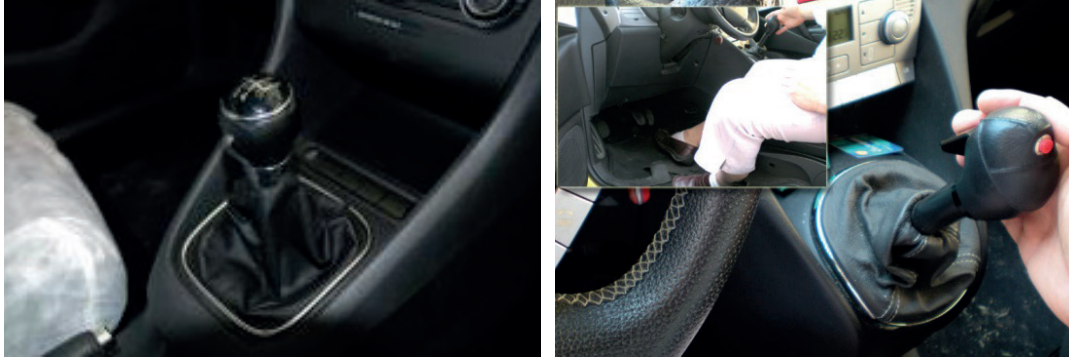
Figura 13. EMBRAGUE ELECTRONICO FADIEL con accionamiento mediante pomo con palanca, táctil o sistema de sensor infrarrojo, distribuido por Euromobility y que instala Rehatrans. Agosto 2015.
