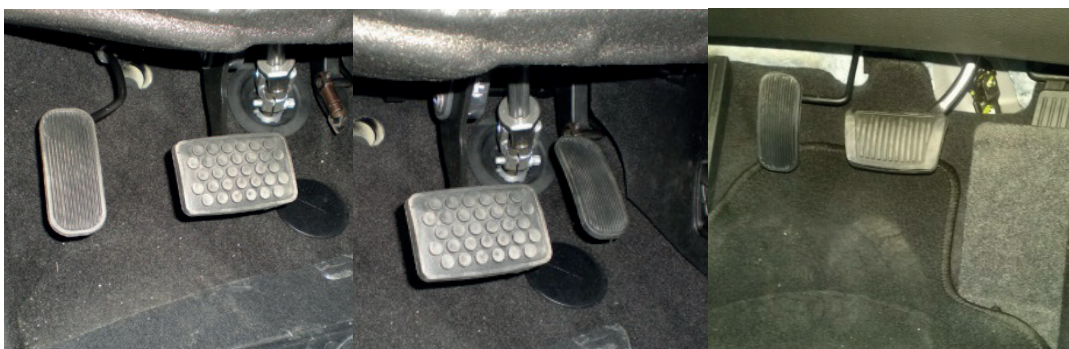
Figura 14. INVERSOR DE ACELERADOR fabricadas y diseñadas por Fadiel, distribuidas por Euromobility y que instala Rehatrans. Mecanismos y posibilidades Agosto de 2015.
