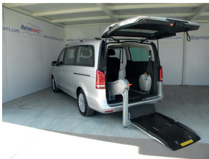
Figura 24. Plataforma elevadora Fiorella distribuye e instala Rehatrans. Agosto 2015.
