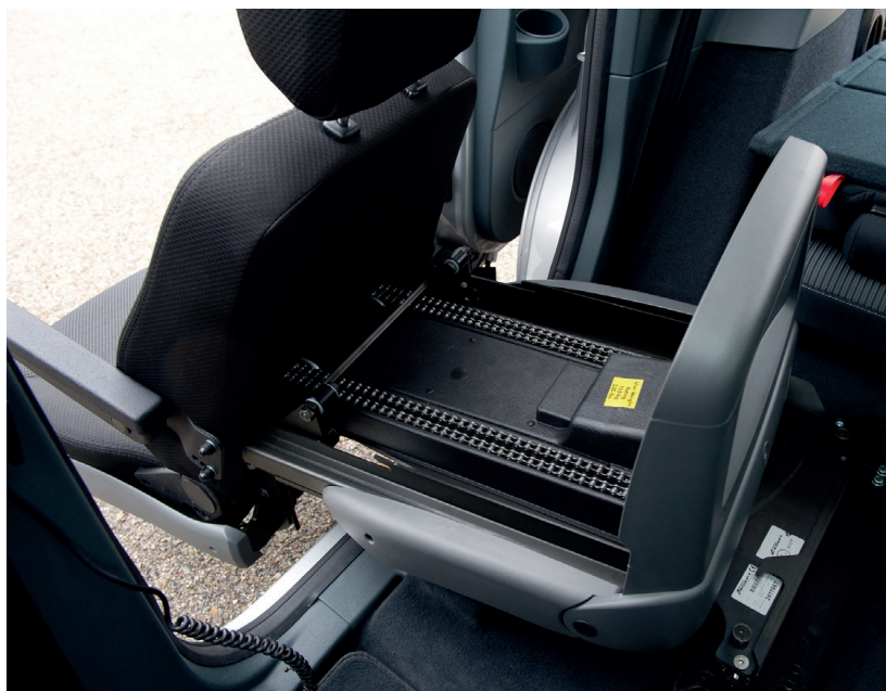
Figura 3. Instalación de asientos giratorios asistidos para facilitar la transferencia de la persona de movilidad reducida a/desde la silla de ruedas (Fuente: FORD Adapta).
