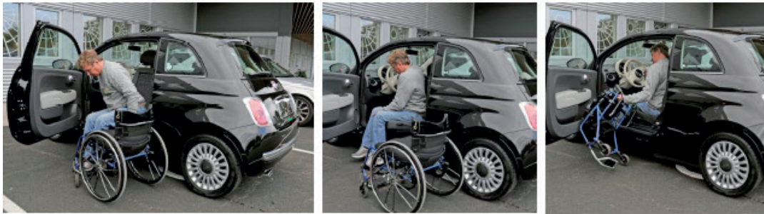
Figura 22. Carga de silla de manera manual desde Turnout 2E automático de la marca Autoadapt, distribuye e instala Rehatrans. Agosto 2015.
