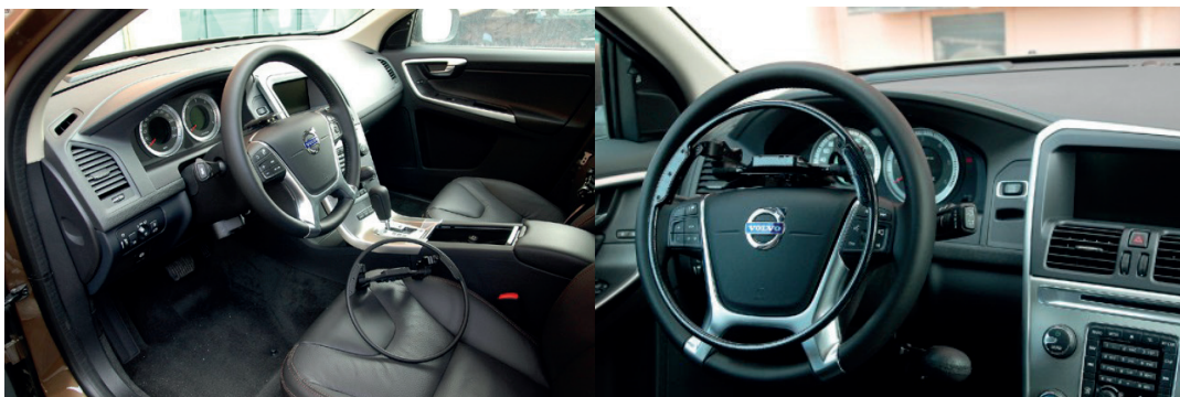
Figura 1. Acelerador extraíble diseñado y fabricado por FADIEL distribuido por Euromobility y que instala Rehatrans. Agosto 2015.
