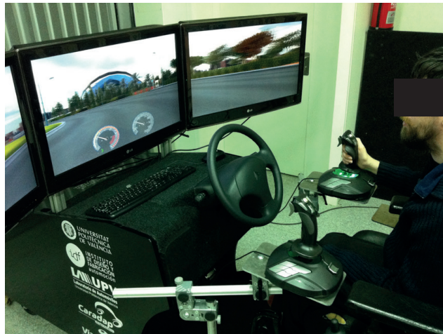
Figura 10. Ejercicio simulado de conducción en curvas (rotondas) mediante el accionamiento de mandos de tipo Joystick.
