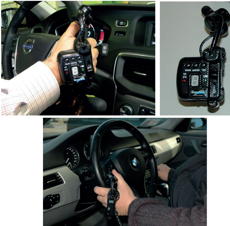
Figura 2. Acelerador extraíble diseñado y fabricado por FADIEL distribuido por Euromobility y que instala Rehatrans. Agosto 2015.
