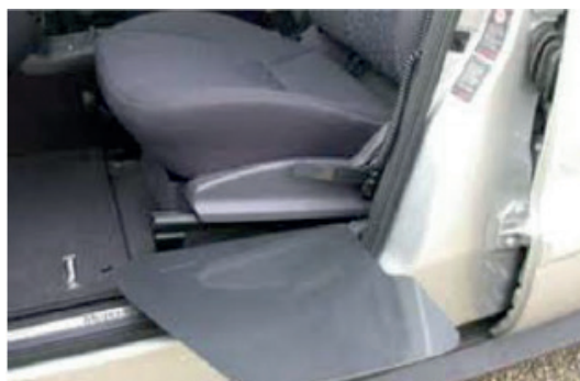
Figura 21. Tabla de transferencia motorizada. Fuente: Fig. 11 de Pág. 17 en Norma UNE 26494:2014.
