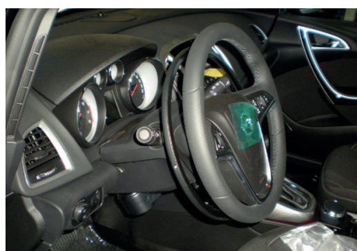
Figura 4. Acelerador aro bajo volante FR34 diseñado y fabricado por FADIEL distribuido por Euromobility y que instala Rehatrans. Agosto 2015.
