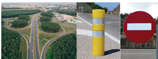
Figura 12. Geometría, balizamiento y señalización de los nudos viarios. Fuente: Elaboración propia
