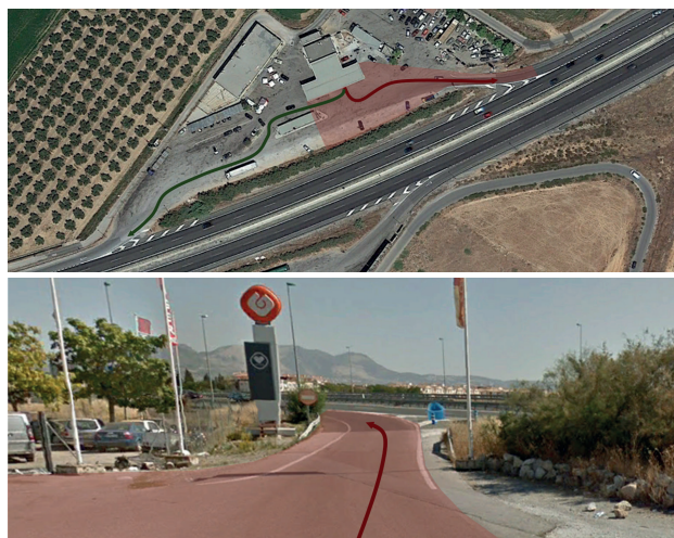
Figura 34. Áreas de servicio con acceso y salidas no canalizadas y con necesidad de refuerzo de señalización vertical. Fuente: Google Earth, 2019
