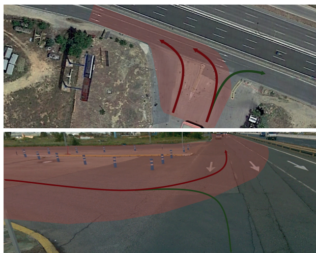
Figura 35. Áreas de servicio con ausencia de marcas viales y carencias de balizamiento. Fuente: Google Earth, 2019
