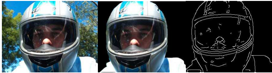
Figura 10.- Extracción de bordes (imagen derecha) para una imagen de entrada (imagen izquierda) tras eliminar los píxeles cuya distancia a la cámara es mayor que un umbral prefijado (imagen central).
