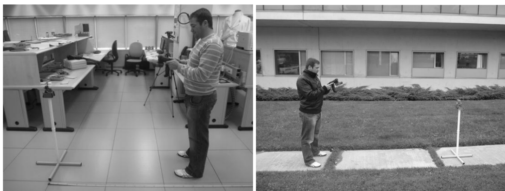
Figura 19 - Escenarios indoor (izquierda) y outdoor (derecha) utilizados por la empresa Farsens Solutions con el objeto de comprobar el alcance de su sistema RFID ((©Farsens Solutions).
