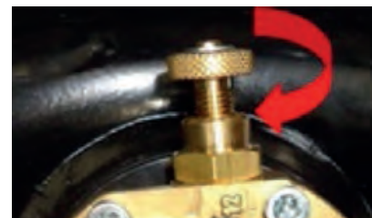
Llave de cierre depósito de GLP
