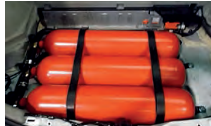
Depósitos en un Toyota Prius híbrido convertido a GNC
