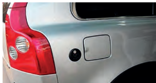
Boca de llenado GLP separada
