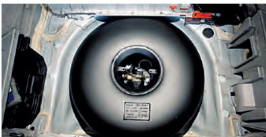
Diferente ubicación del depósito toroidal GLP en un turismo
