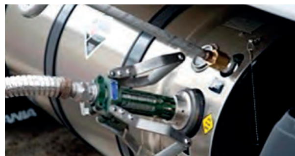
Boca de llenado GNL en un camión
