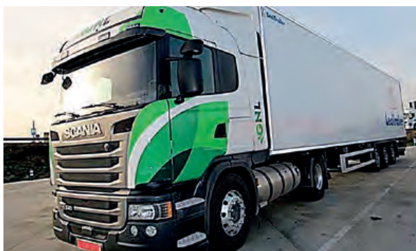
Scania G340 Streamline con dos depósitos de GNL
