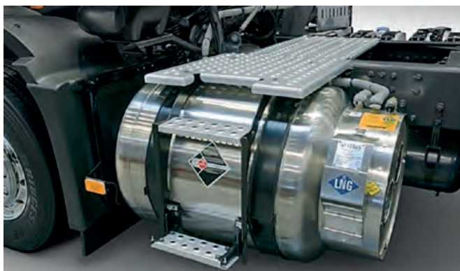
Depósito GNL en un camión Dual-Fuel
