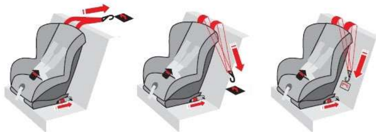
Figura 10. Ejemplo del sistema de fijación Top Tether
