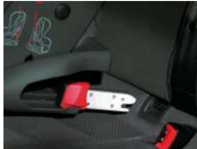
Figura 9. Ejemplo de sistema ISOFIX. A la izquierda la pinza metálica del SRI para anclarse al dispositivo fijado en el vehículo
