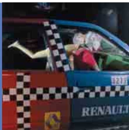
SUELTO. Sin el adecuado sistema de retención, el niño puede, en caso de accidente y aunque la velocidad sea muy baja, salir disparado contra el parabrisas.
