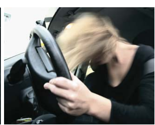
➤ En un choque frontal, la cabeza del conductor sale lanzada primero hacia adelante y luego hacia detrás. El cinturón de seguridad evita que se estrelle contra el volante.
