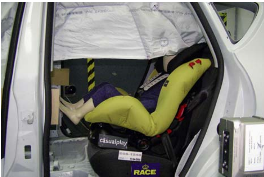
► El airbag lateral que se despliega ante un impacto protege al menor y no le causa daño alguno.
