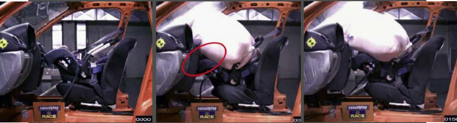
► El crash test demuestra cómo el muñeco se golpea la cabeza contra el salpicadero y es aplastado por la bolsa de aire frontal en cuestión de milisegundos.
