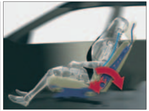
► En el sistema WHIPS de Volvo actúan juntos el asiento y el reposacabezas. Lo equipan de serie todos sus modelos y ha obtenido las mejores calificaciones.
