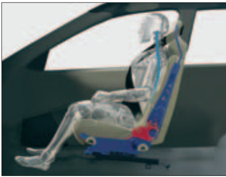
► En el sistema WHIPS de Volvo actúan juntos el asiento y el reposacabezas. Lo equipan de serie todos sus modelos y ha obtenido las mejores calificaciones.
