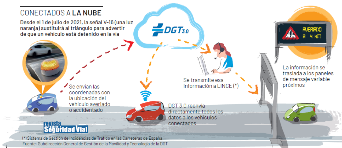
Ilustración 2. Esquema de funcionamiento de la señal V-16. Fuente: DGT
