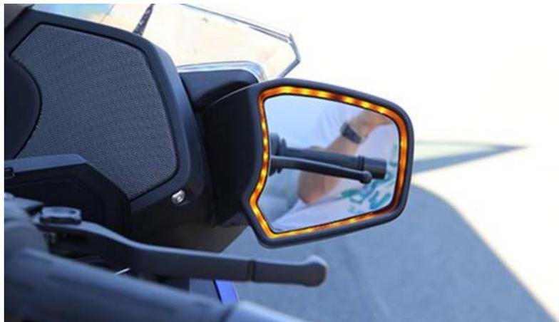
**Figura 39. Sistema HMI del detector de ángulo muerto (BSD) de Continental.**
