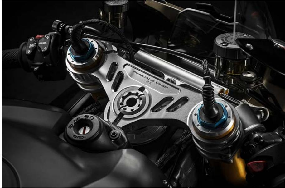
**Figura 42. Válvulas de regulación del amortiguador delantero en el sistema de suspensión electrónica de la Ducati Panigale V4 SP.**
