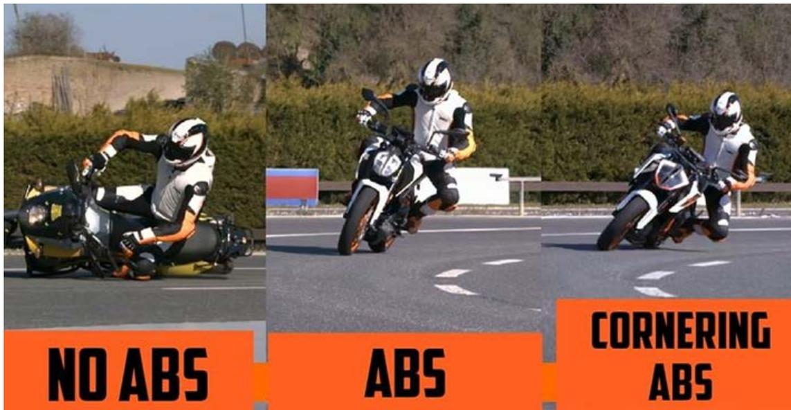
Figura 31. Actuación de sistema Cornering ABS frente a un sistema ABS convencional (<https://www.cartoq.com/ktm-cornering-abs-adventure-390/> ).
