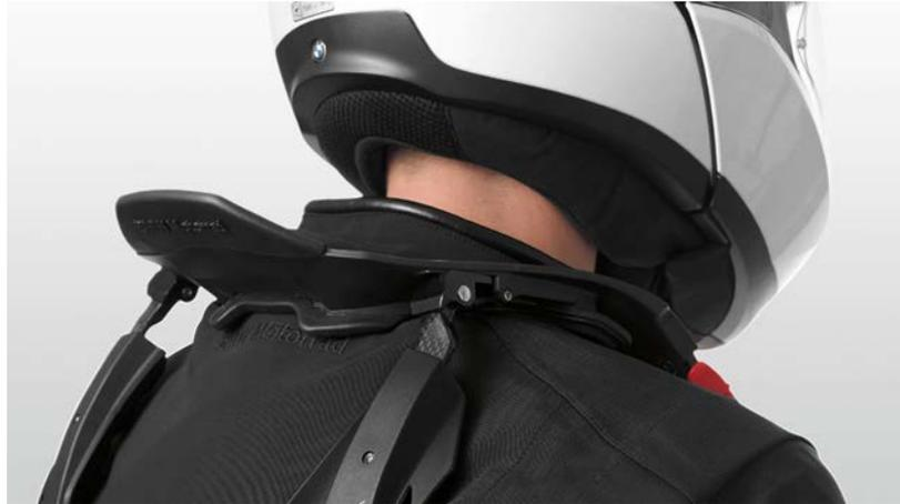
**Figura 58. Sistema de Neck Brace de BMW Motorrad.**
