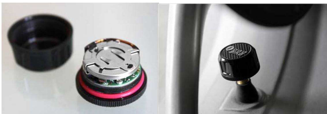
**Figura 25. Sensor de sistema TPMS instalado en el tapón de la válvula (Sistema Fobo Bike).**
