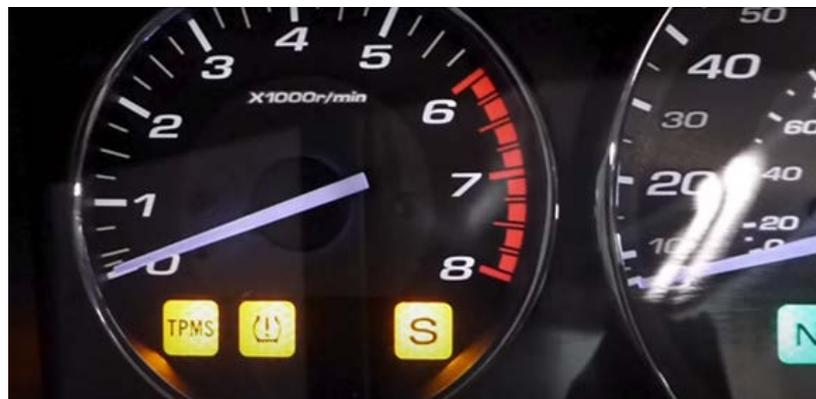
**Figura 22. HMI de sistema TPMS OEM, con indicador de presión inferior a la nominal en el panel de instrumentos (Motocicleta Honda GL1800 Gold Wing).**
