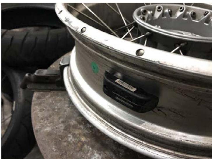
**Figura 24. Sensor de sistema TPMS instalado en la válvula (Sensor RDC en BMW R1200GS LC).**
