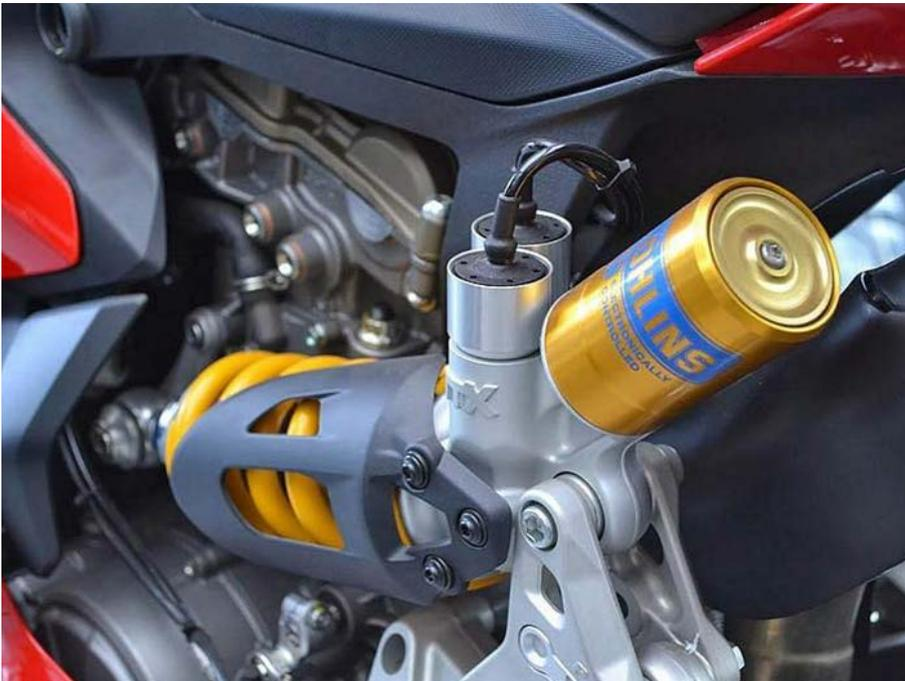
**Figura 41. Válvulas de regulación del amortiguador trasero (Öhlins) en un sistema de suspensión electrónica.**
