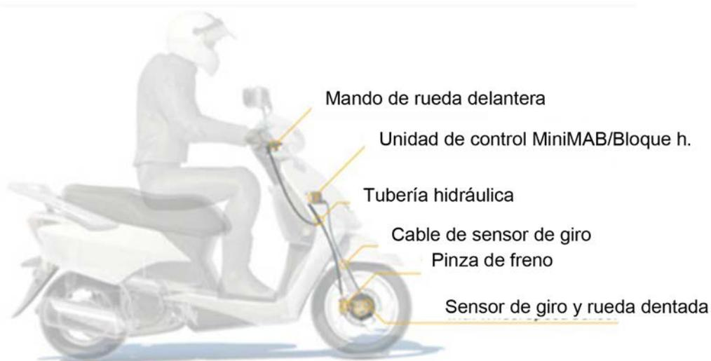
**Figura 27. Configuración de sistema ABS con un canal. Dispositivo ABS MiniMAB de Continental.**
