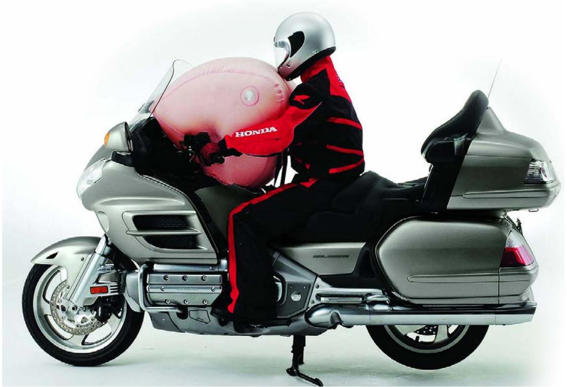
**Figura 44. Sistema airbag en motocicleta Honda Gold Wing.**
