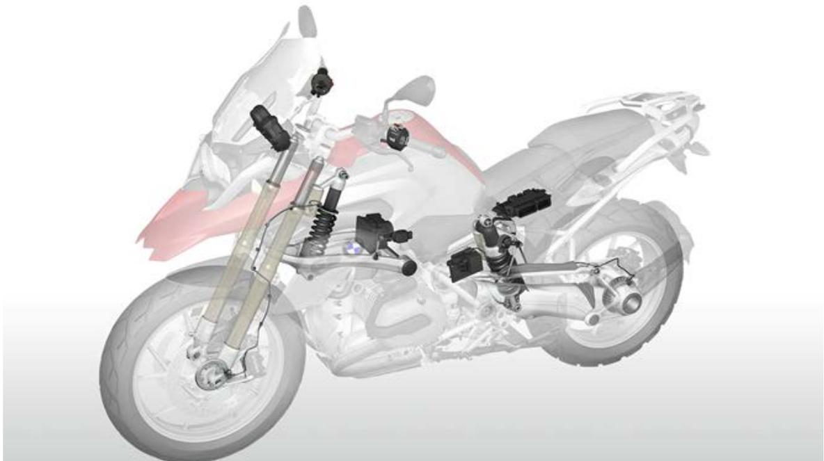
**Figura 40. Sistema de suspensión electrónica Dynamic ESA de BMW Motorrad.**
