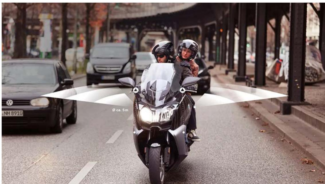
**Figura 36. Sistema asistente de visión lateral SVA de BMW Motorrad.**
