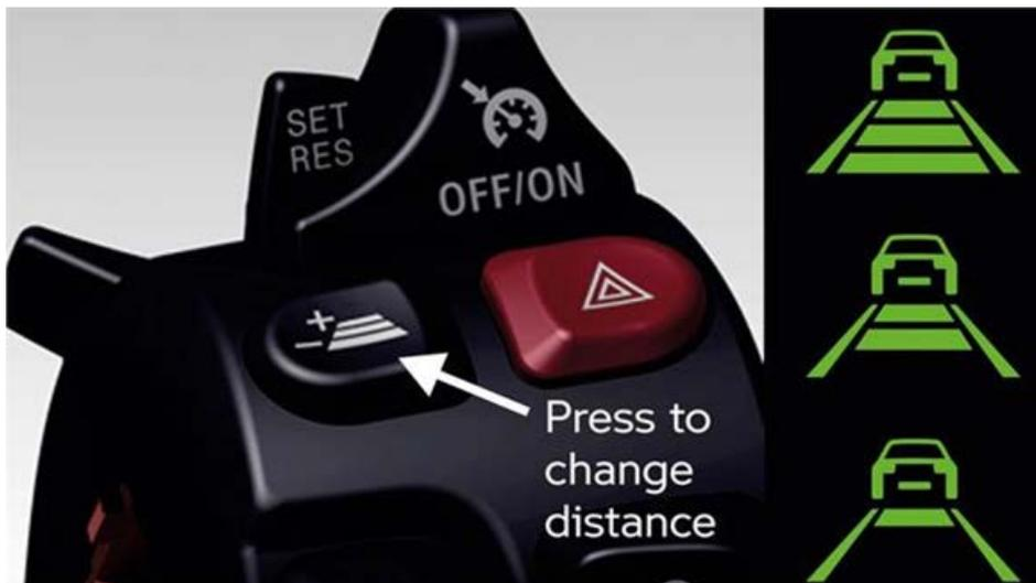
**Figura 35. Modo de activación y sistema HMI del sistema ACC de BMW Motorrad.**
