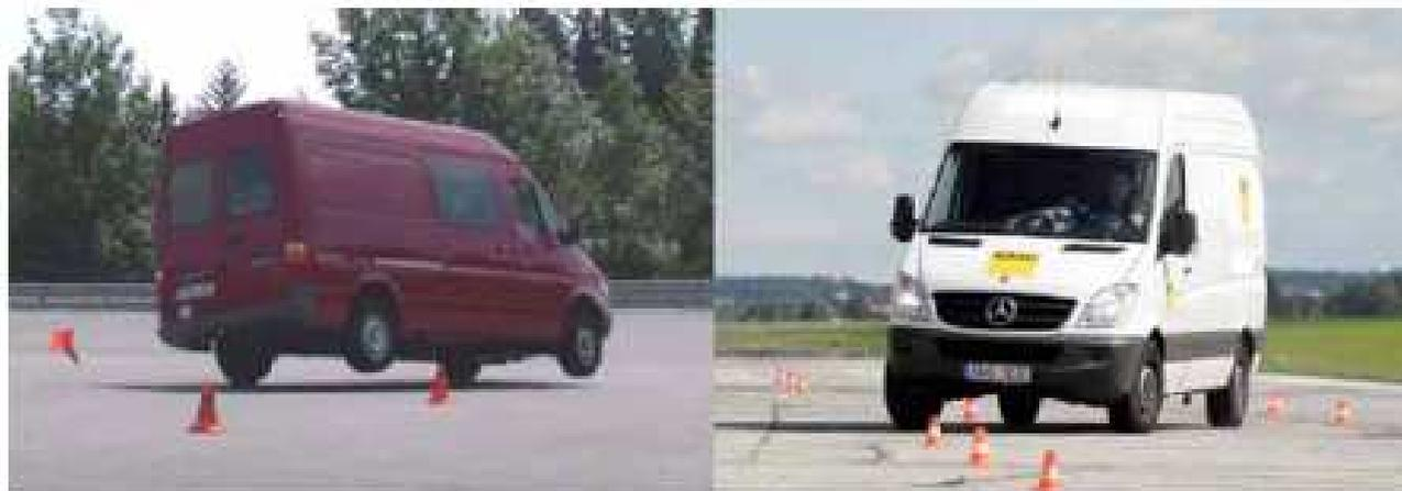
Prueba a 54 Km./h: sin y con ESP
