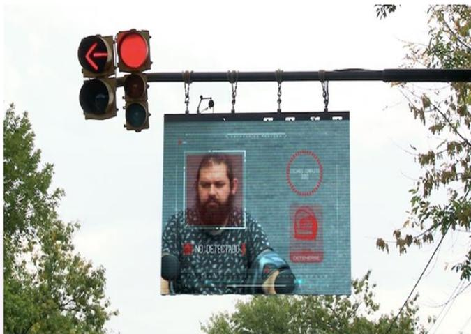
Este semáforo inteligente cuenta con una cámara, que a través de un sistema de reconocimiento facial, detecta automáticamente si el conductor de una moto que se detiene al momento de estar en rojo no tiene colocado casco. El mismo semáforo no se pone en verde hasta el momento en el que el conductor se coloca el casco si es que lo tiene en su poder.
