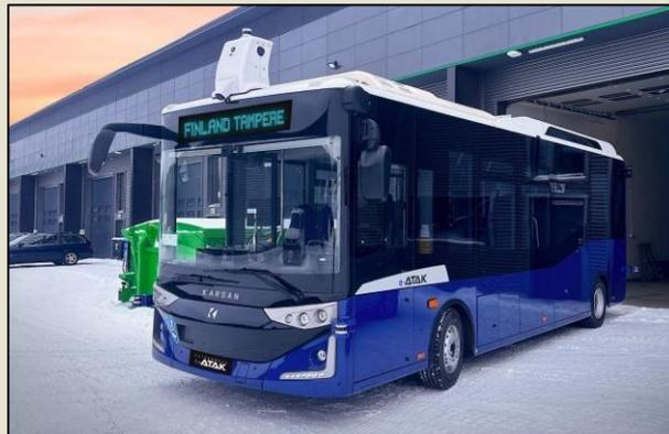
*El autobús está dotado con radares láser, ultrasonidos y al menos tres sistemas de sensores de alta precisión que son capaces de detectar las condiciones de la carretera y del entorno.*
