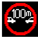
Figura 1. Señalización dinámica aconsejada con nieblas (visibilidad entre 100 y 200 m).
