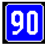
Figura 1. Señalización dinámica aconsejada con nieblas (visibilidad entre 100 y 200 m).
