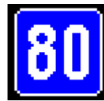
Figura 1. Señalización dinámica aconsejada con nieblas (visibilidad entre 100 y 200 m).
