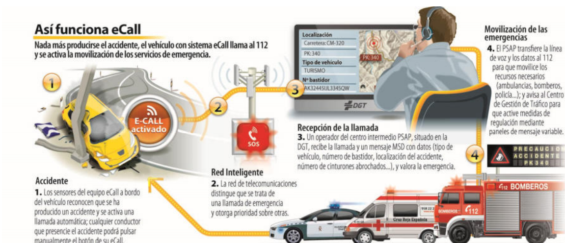
Figura 1. Funcionamiento del sistema eCall
