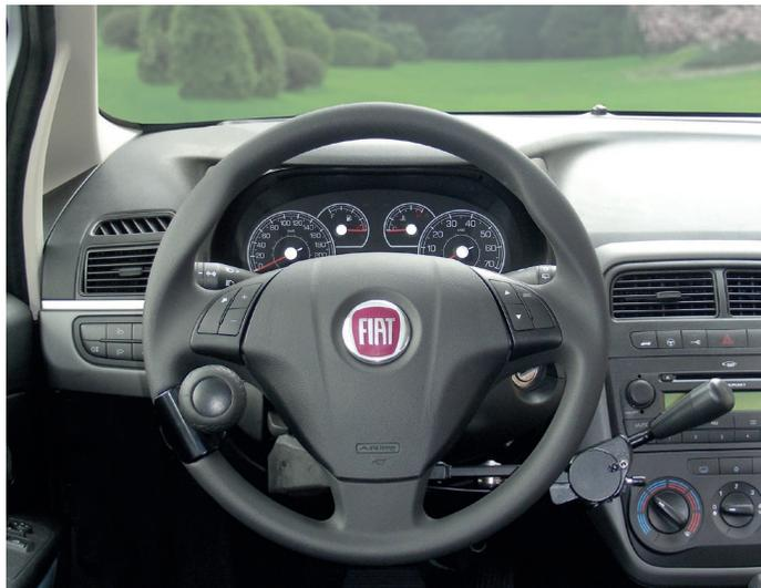
**Figura 43.** Freno de servicio manual por palanca y acelerador manual giratorio accionados con la mano derecha (Fuente: Guidosimplex).
