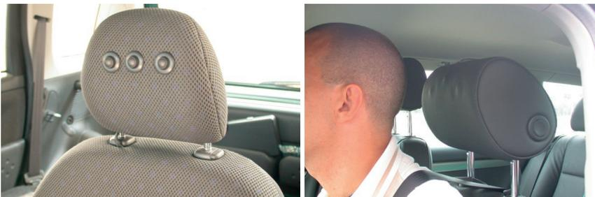
**Figura 62.** Mando de intermitentes incorporado al reposacabezas que va equipado con 3 funciones (Fuente: KIVI-SOLUCIONES ARC).
