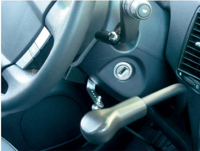
**Figura 21.** Freno de servicio manual por palanca de accionamiento vertical con fuerza de empuje descendente (Fuente: KIVI-SOLUCIONES ARC).
