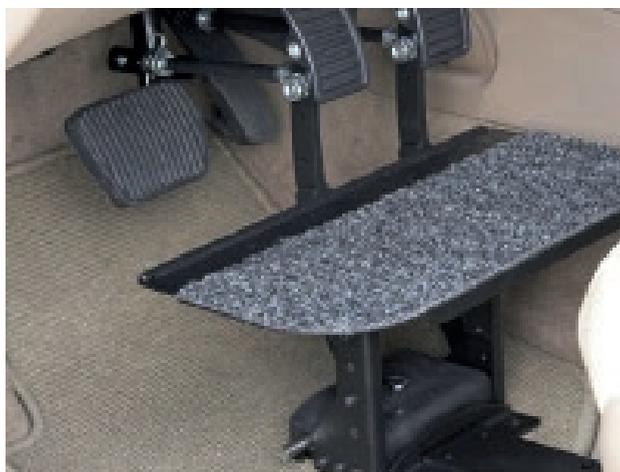
**Figura 18.** Base elevada para el acercamiento de los pedales a las extremidades del conductor (Fuente: Euromobility).
