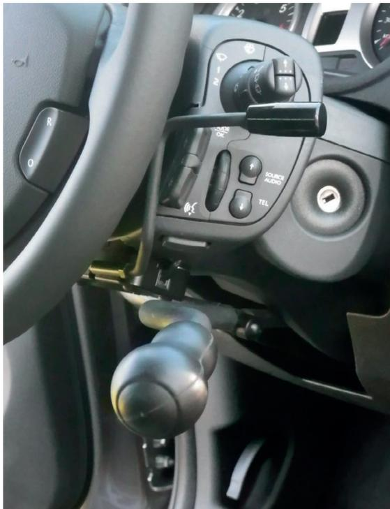
**Figura 22.** Freno de servicio manual por palanca horizontal con fuerza de empuje horizontal hacia delante (Fuente: Sojadis-ILUNION Adaptación de vehículos).
