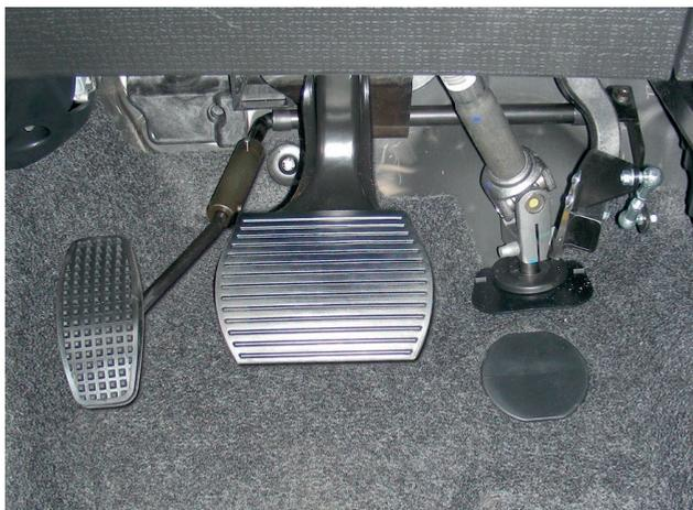
**Figura 17.** Pedal de freno adaptado con ampliación de su anchura (Fuente: Guidosimplex).
