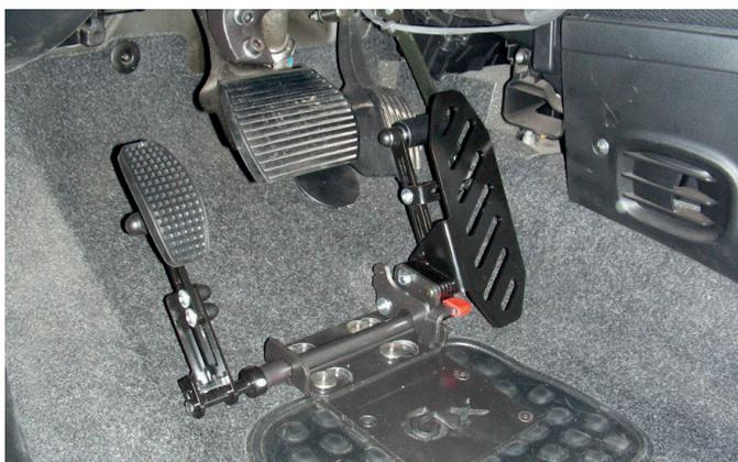
**Figura 38.** Pedal del acelerador original protegido y pedal al pie izquierdo escamoteable (Fuente: Guidosimplex).
