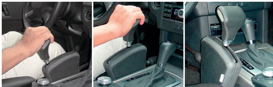
Figura 44. Freno y acelerador manual por palanca vertical (Fuente: Guidosimplex).
