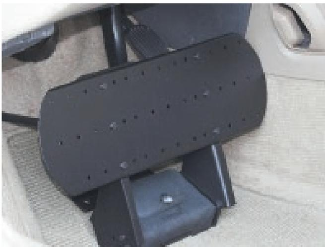
**Figura 40.** Medida para prevenir el accionamiento de los pedales (Fuente: Euromobility).
