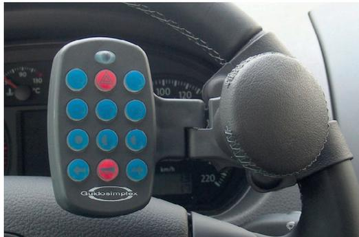
**Figura 58.** Modelo de Telecomando por infrarrojos accionado sin soltar el volante con la mano derecha 12 funciones (Fuente: Guidosimplex).
