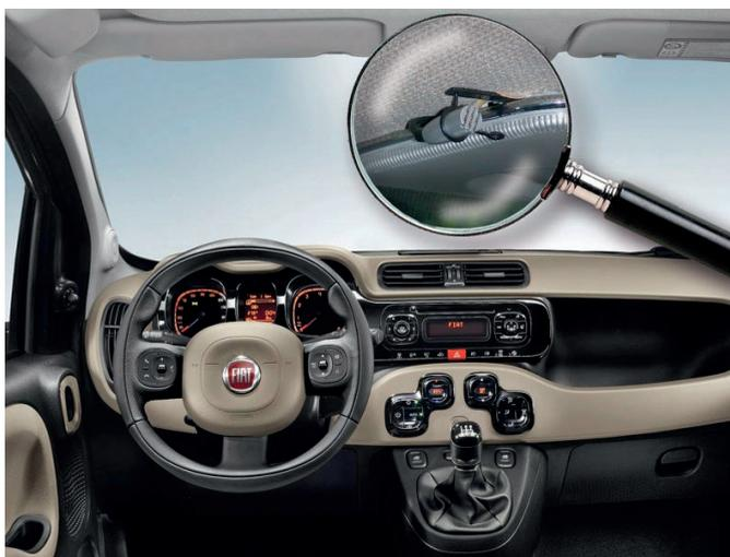
**Figura 64.** Sistemas para el accionamiento de los mandos complementarios del vehículo por reconocimiento de voz (Fuente: Guidosimplex).
