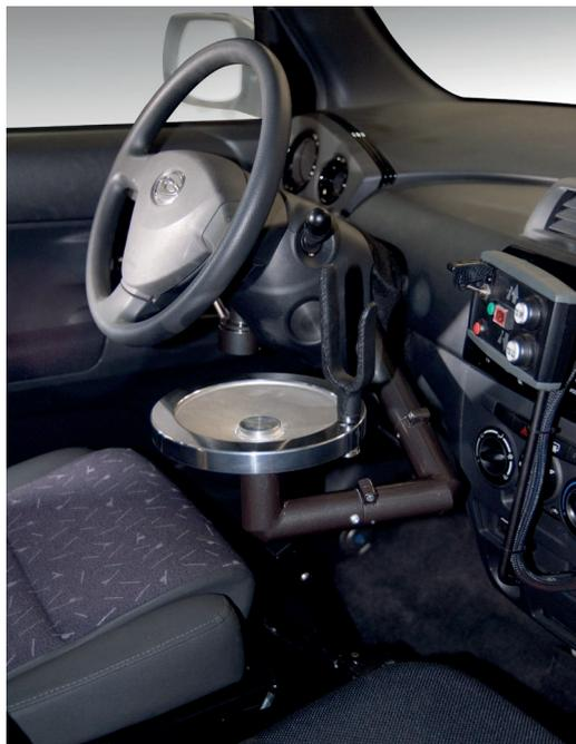
**Figura 68.** Dirección tipo joystick de 2 vías accionada por volante horizontal (Fuente: KIVI-SOLUCIONES ARC).
