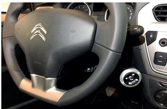
Figura 60. Caja de pulsadores para inversión de luces e intermitentes al lado derecho del volante (Fuente: Euromobility).
