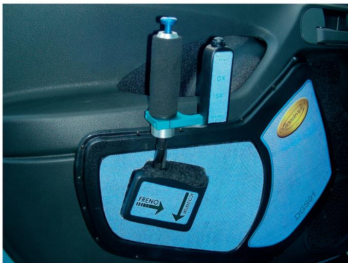
Figura 49. Transformación para tetraplégicos con mandos de accionamiento electrónico (Fuente Guidosimplex).
