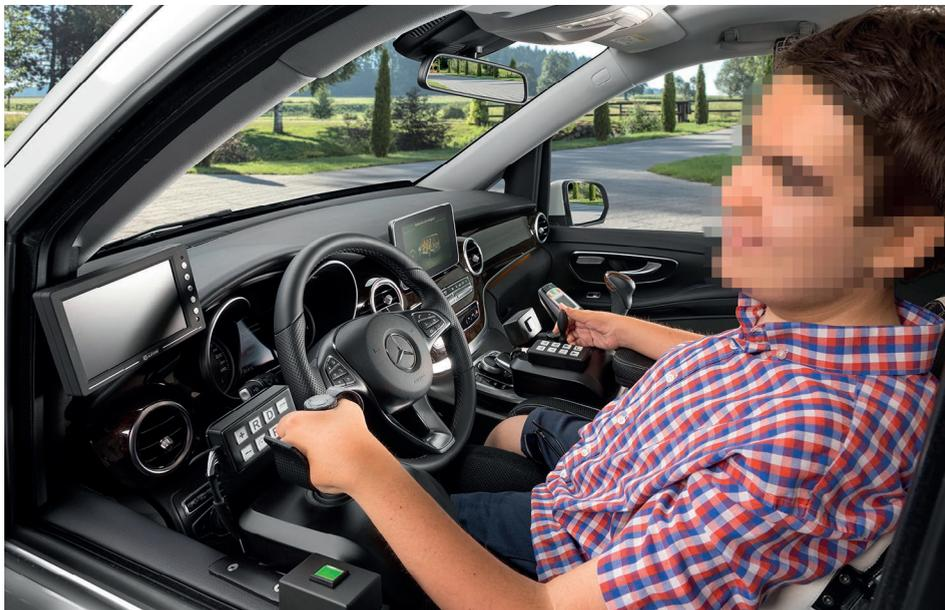
**Figura 7.** Selector electrónico para cambio de velocidades automático
