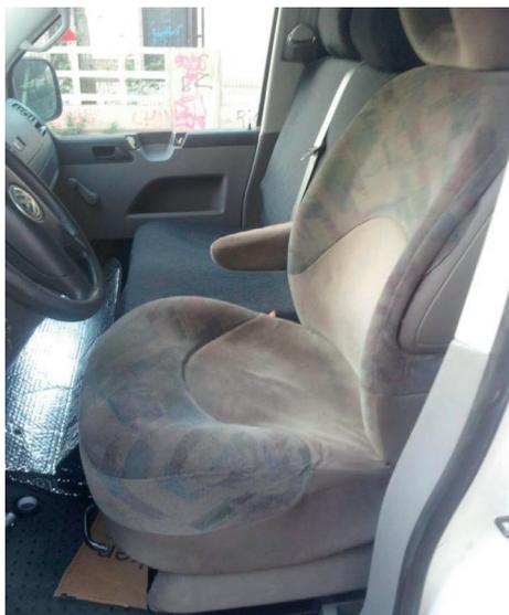
**Figura 74.** Asiento del conductor elevado para conseguir una visión normal (Fuente: Soluciones ARC).
