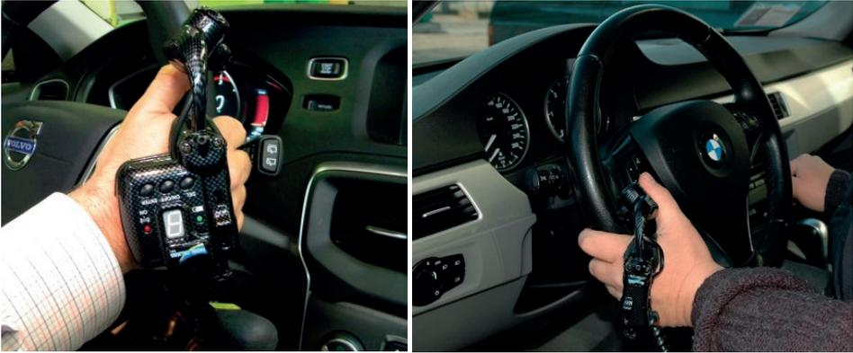
Figura 35. Acelerador manual con pulsador (Fuente: Euromobility).
