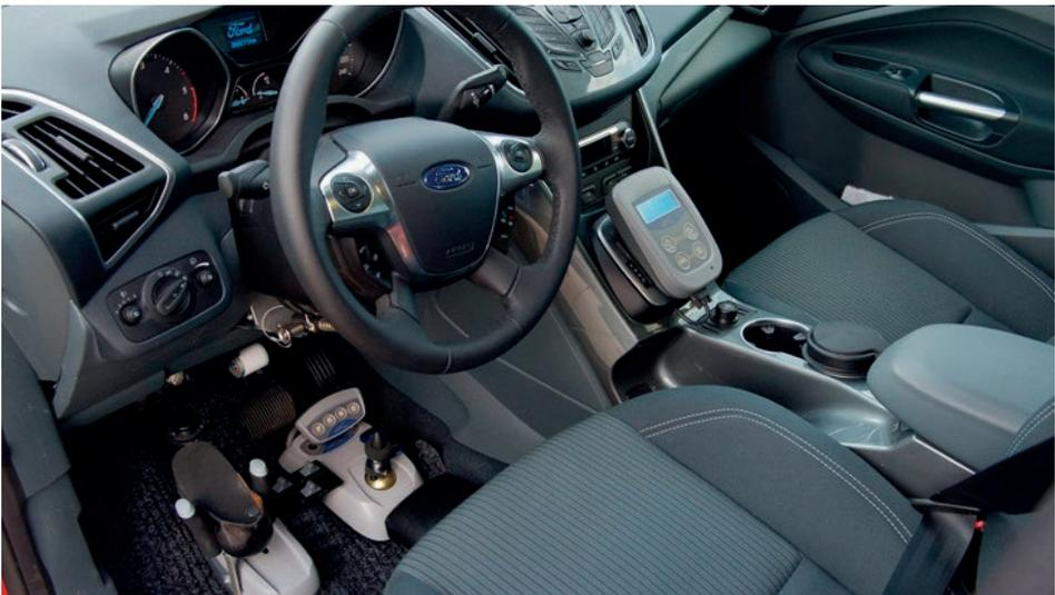
**Figura 65.** Sistemas para el accionamiento de la dirección al pie con joystick (Fuente: PARAVAN-FORD ADAPTA).
