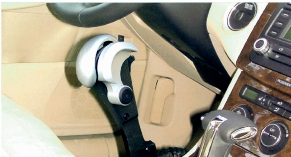
**Figura 48.** Transformación para mandos combinados de freno mecánico y accionamiento electrónico del acelerador con el brazo izquierdo (Fuente Guidosimplex).
