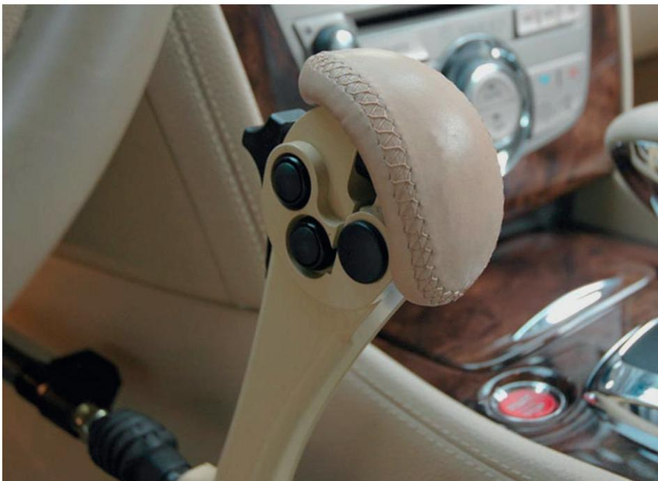
**Figura 20.** Freno de servicio manual por palanca vertical con fuerza de empuje hacia delante sobre un plano vertical (Fuente: Guidosimplex).
