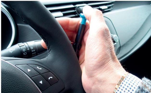
Figura 36. Acelerador manual con pulsador (Fuente: Guidosimplex).
