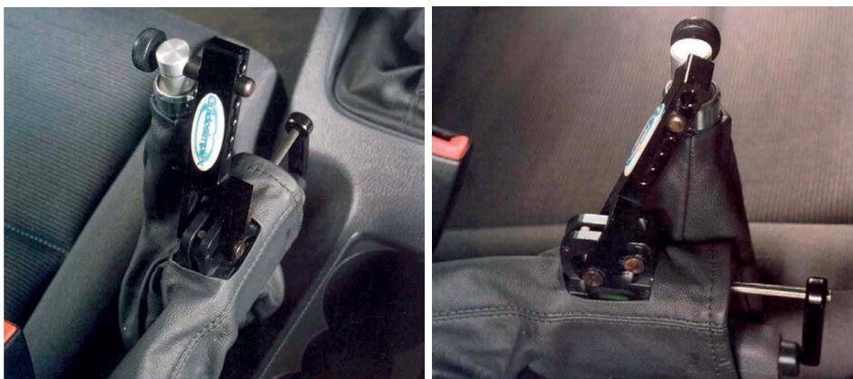
**Figura 24.** Accionamiento eléctrico de la palanca del freno de estacionamiento (Fuente: Guidosimplex).
