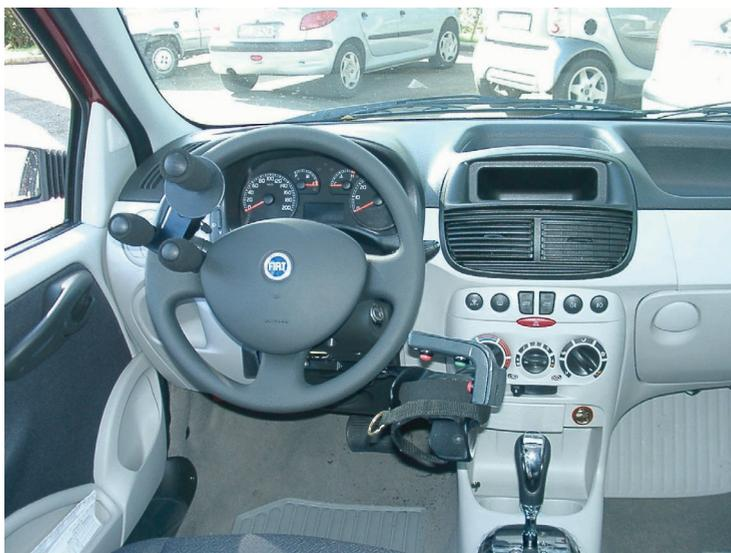
**Figura 46.** Transformación para tetraplégicos con mandos electrónicos de accionamiento manual con el brazo derecho (Fuente Guidosimplex).
