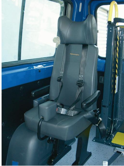
Figura 79. Adaptación del cinturón de seguridad con soporte para mejorar la estabilidad (Fuente: Guidosimplex).
