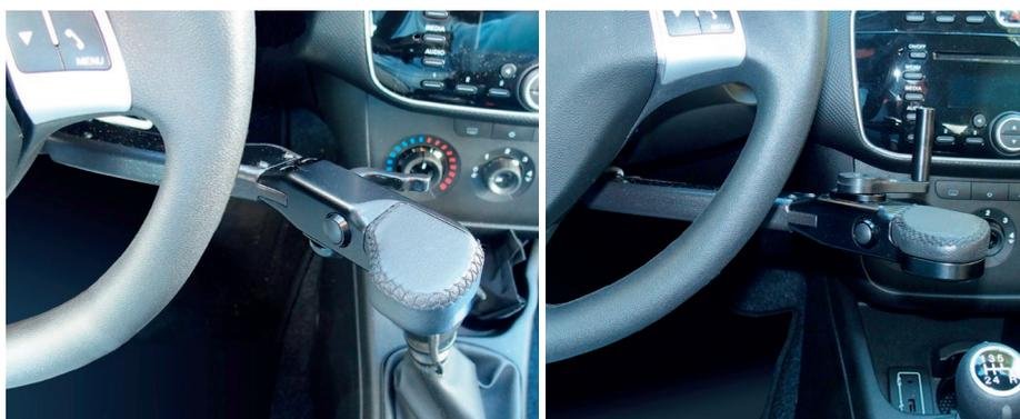
**Figura 47.** Transformación para mandos combinados de freno mecánico y accionamiento electrónico del acelerador con el brazo derecho (Fuente Guidosimplex).
