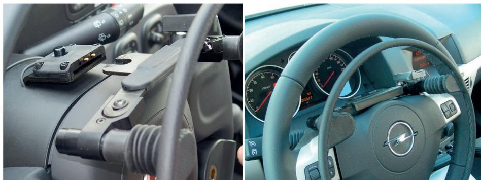
**Figura 29.** Acelerador electrónico de aro concéntrico instalado en la parte frontal del volante y desmontable (Fuente: Guidosimplex).
