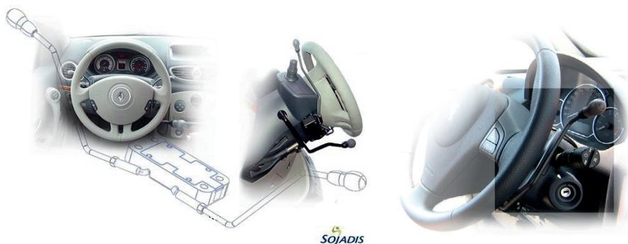
**Figura 31.** Acelerador manual de palanca de giro radial (Fuente: Sojadis-ILUNION Adaptación de vehículos).
