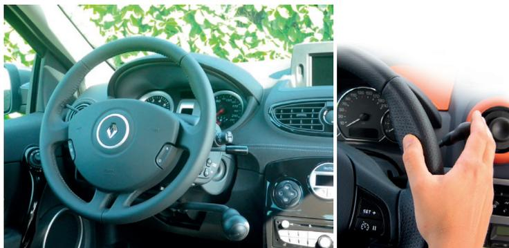
**Figura 33.** Acelerador manual tipo leva a la mano derecha (Fuente: Sojadis-ILUNION Adaptación de vehículos).
