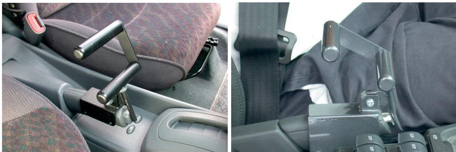
**Figura 23.** Sistema de ayuda a la conducción para sujetar la empuñadura de la palanca del freno de estacionamiento mediante un elemento suplementario (Fuente: KIVI-SOLUCIONES ARC).
