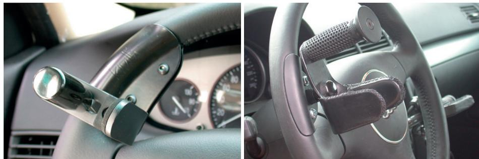
Figura 56. Sistema de sujeción del volante con horquilla de dos y tres puntas (Fuente: KIVI-SOLUCIONES ARC).
