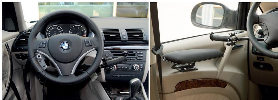
Figura 32. Acelerador manual tipo empuñadura (Fuente: KIVI-SOLUCIONES ARC).
