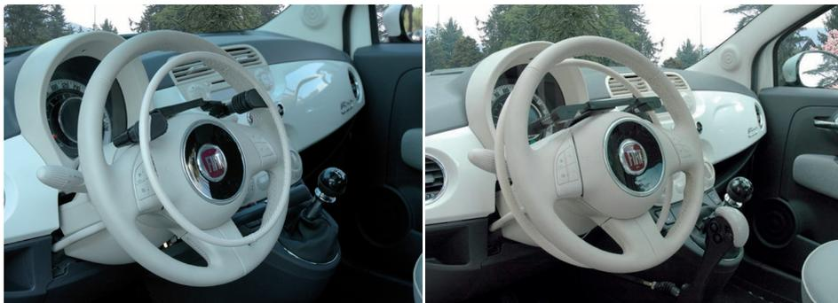
**Figura 28.** Acelerador de aro concéntrico. Izquierda: instalado por delante del volante. Derecha: instalado por la parte trasera del volante (Fuente: Guidosimplex).
