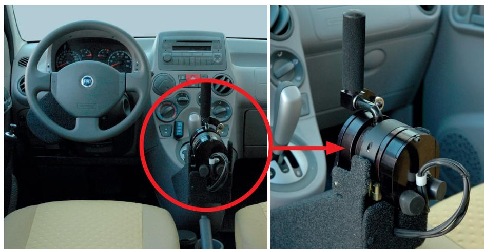
**Figura 69.** Dirección con joystick de 2 vías accionada por palanca (Fuente: Guidosimplex).
