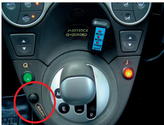
Figura 63. Pulsador de arranque del vehículo mediante interruptor (Fuente: Guidosimplex).
