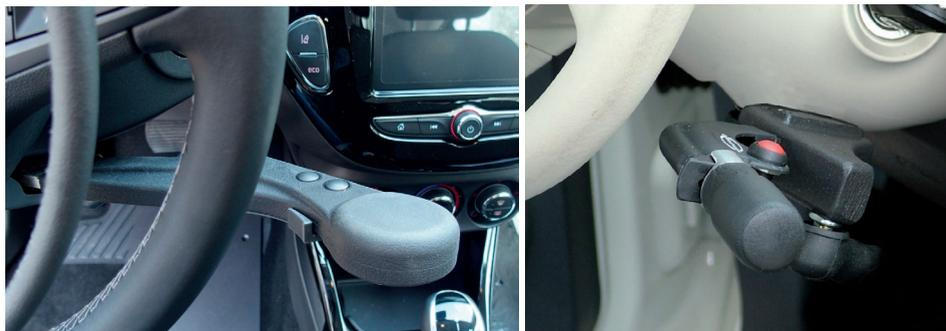
**Figura 19.** Ejemplos de freno de servicio manual con fuerza de empuje hacia delante sobre un plano horizontal (Fuente: Guidosimplex).
