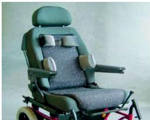
**Figura 75.** Asiento del conductor adaptado a la forma del cuerpo (Fuente: Soluciones ARC).
