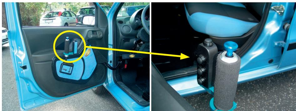
**Figura 34.** Acelerador electrónico para conductores con discapacidades severas accionado con la mano izquierda por medio de un pulsador vertical (Fuente: Guidosimplex).
