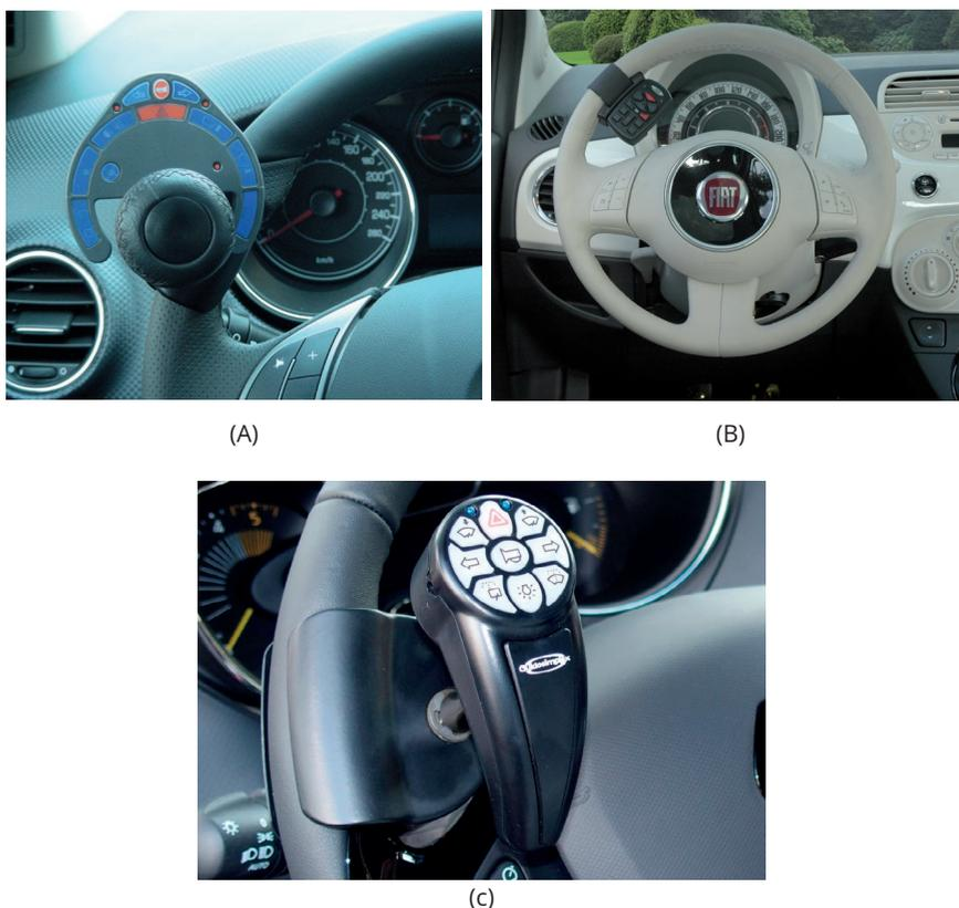
**Figura 57.** Modelos de Telecomando por infrarrojos accionado sin soltar el volante con la mano izquierda. (A) de 11 funciones, (B) de 12 funciones, (C) de 9 funciones (Fuente: Guidosimplex).
