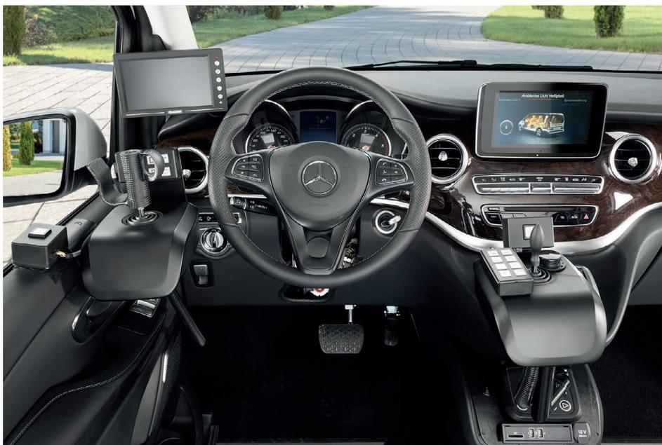
**Figura 50.** Transformación para tetrapléjicos con mandos electrónicos de aceleración y frenado (Fuente PARAVAN-ILUNION Adaptación de vehículos).
