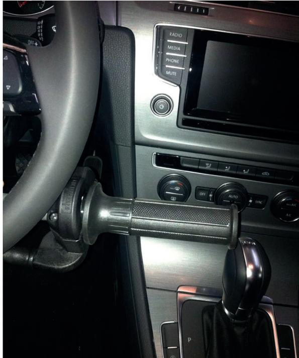
**Figura 45.** Transformación para tetrapléjicos con mandos electrónicos de accionamiento manual y accionados con el brazo derecho (Fuente Euromobility).
