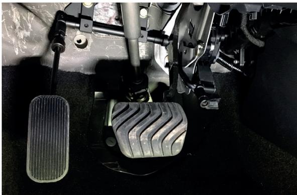
**Figura 37.** Pedal del acelerador al pie izquierdo (Fuente: Euromobility).
