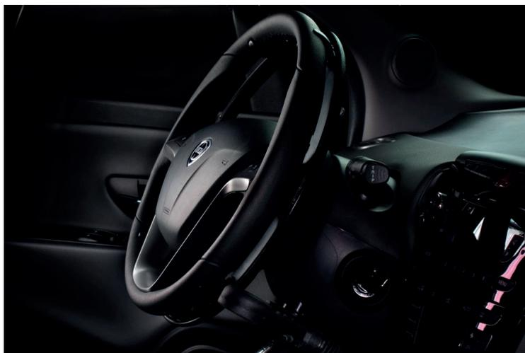
**Figura 30.** Acelerador electrónico de aro concéntrico con giro radial instalado en la parte trasera del volante (Fuente: Guidosimplex).
