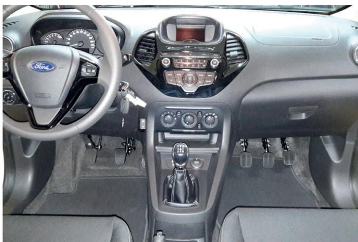
Figura 39. Doble juego de pedales para el aprendizaje del conductor con discapacidad (Fuente: Euromobility).
