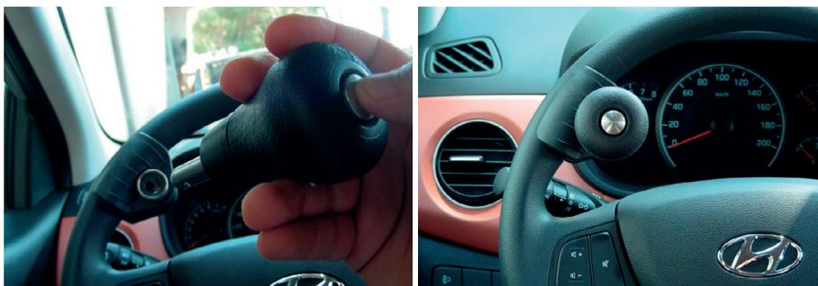
Figura 54. Sistema de sujeción del volante con pomo desmontable (Fuente: Guidosimplex).
