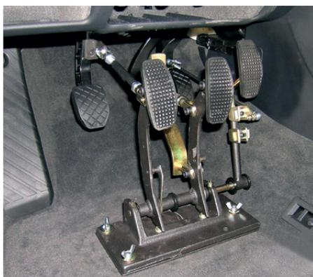
Figura 12. Suplemento al pedal del embrague, freno y acelerador para casos de enanismos o baja estatura (Fuente: Guidosimplex).
