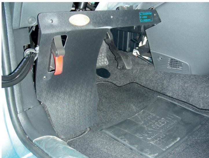
Figura 16. Medida para prevenir el accionamiento del pedal de embrague (Fuente: Guidosimplex).
