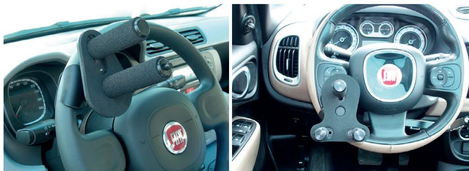
Figura 55. Sistema de sujeción del volante con horquilla de dos y tres puntas (Fuente: Guidosimplex).
