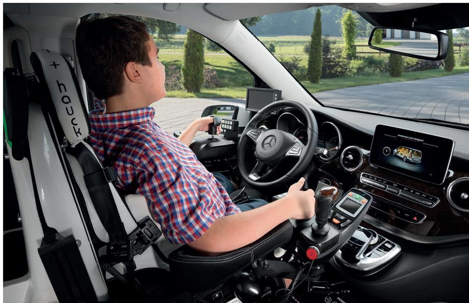
**Figura 67.** Diferentes alternativas para el accionamiento de un sistema de dirección por joystick de 2 vías
