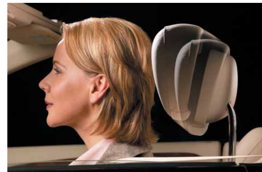
► El reposacabezas activo "Neck-Pro" de Mercedes se desliza hacia delante y hacia arriba
